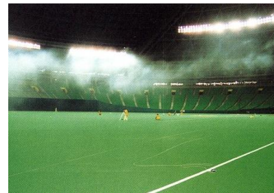
旋回流の可視化実験
