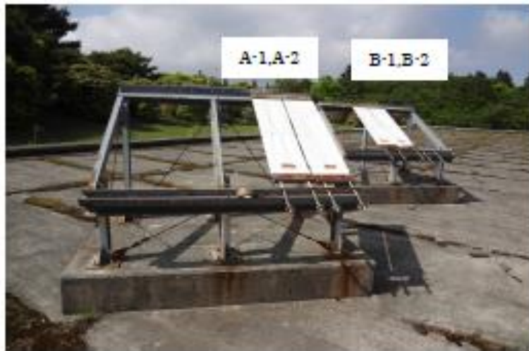
曝露試験台の設置状況
