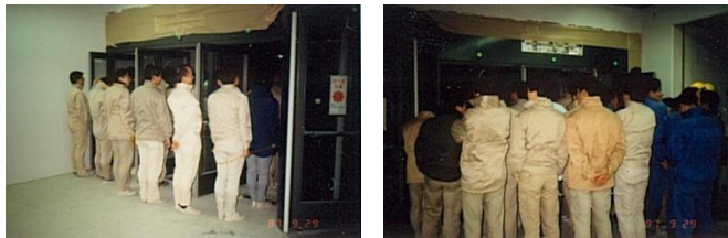
避難扉での漏気量計測状況
