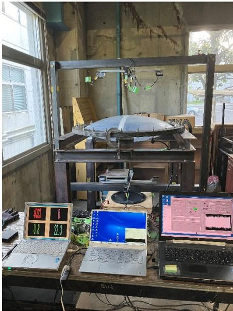
図5 音圧加振実験試験体設置概要
