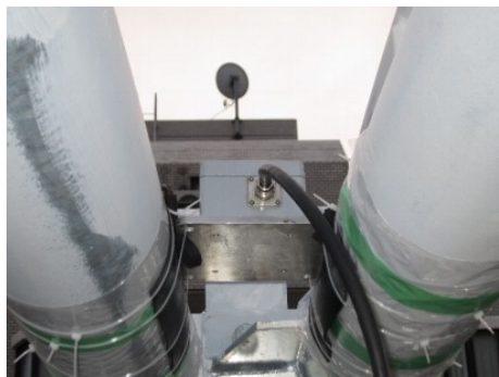
写真4 加速度センサー固定状況 (センサー仕様)
